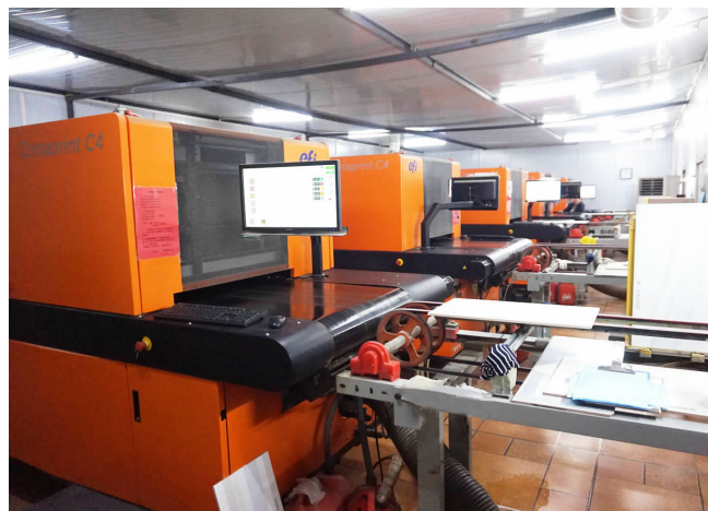
为丰富瓷片花色、提升竞争力,广西禾康陶瓷批量引进国内外高端喷墨打印机,仅2条生产线就上线了11台喷墨机。
